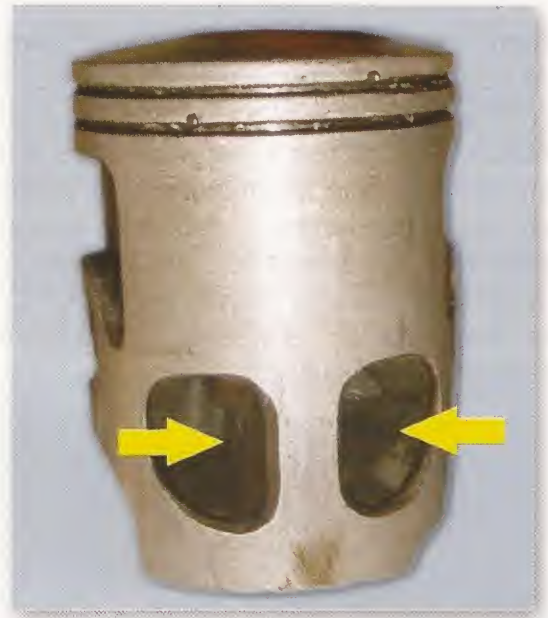
Detalle del pistón con falda perforada
